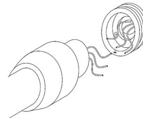
7- Fissare l'articolo serrando i grani e infine mandare a battuta i rosoni **Attenzione! Solo dopo questa operazione si può riattivare la rete elettrica!**/ Secure the article by tightening the grains and finally sending the rosettes up **(Attention! Only after this operation you can turn on the power supply!)**/ Закрепите изделие, затянув зерно и, наконец, поместите розеточки вверх **(Внимание! Только после этой операции вы можете включить источник питания)**
