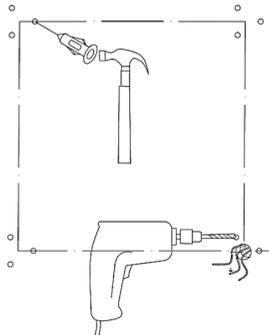
4- Fissare le flange a muro in dotazione ed avvitare i raccordi su di esse (solo per quelle a muroo/ Fix the supplied flanges and screw the fittings on them (only for wall mounts / Закрепите прилагаемые фланцы и завинтите фитинги на них (только для настенных креплений)
