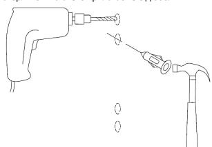
6- Fissare gli attacchi a muro con le viti in dotazione/ Attach the wall mountings to the supplied screws/ Прикрепите настенные крепления к прилагаемым винтам.
