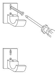
7- Avvicinare l'articolo, serrare i rubinetti, mandare a battuta il cappuccio scorrevole e serrare l'apposita vite/Attach the article, tighten the taps, slice the sliding cap and tighten the special screw/ Прикрепите изделие, затяните краны, отрежьте скользящую крышку и затяните специальный винт
