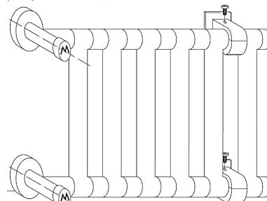
8- Sfiatare, anche più volte fino al corretto riscaldamento, agendo sugli sfiati superiori/ Breath, even several times until proper heating, by acting on the upper vent/ Дышите, даже несколько раз, до надлежащего нагрева, действуя на верхнее отверстие
