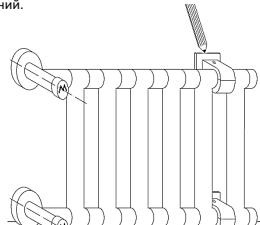
5- Smontare l'articolo, forare ed inserire i tasselli in dotazione/ Remove the item, drill and insert the supplied dowels/ Снимите изделие, сверлите и вставьте прилагаемые дюбели.
