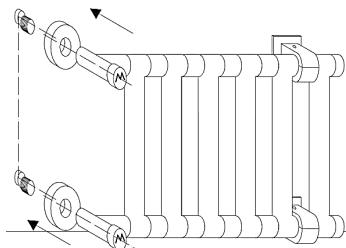
4- Dopo aver appoggiato l'articolo alla parete segnare le posizioni per gli attacchi a muro superiori/ After placing the article on the wall, mark the positions for the upper wall connections/ После помещения изделия на стену отметьте положение для верхних стенных соединений.
