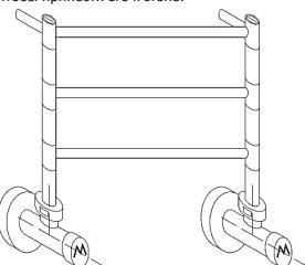
3- Segnare sulla parete la posizione per gli attacchi a muro e i relativi fori/ Point the wall for the wall mounts and their holes/ Нарисуйте стену на настенные крепления и их отверстия.
