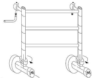
7- Sfiatare, anche più volte fino al corretto riscaldamento, agendo sugli sfiati superiori/ Breathe, even several times until proper heating, by acting on the upper vent/ Дышите, даже несколько раз, до надлежащего нагрева, действуя на верхнее отверстие.
