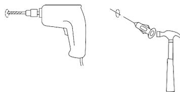
5- Fissare gli attacchi a muro con le viti in dotazione/ Attach the wall mountings to the supplied screws/ Прикрепите настенные крепления к прилагаемым винтам.
