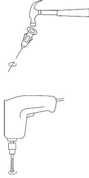
5- Fissare gli attacchi a muro con le viti in dotazione/ Attach the wall
