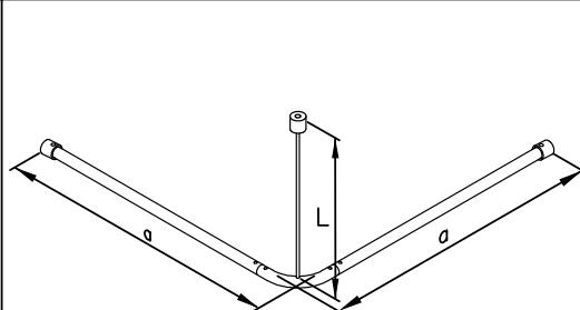
(FR) Déterminer la mesure a depuis le mur jusqu'au milieu du tube.
